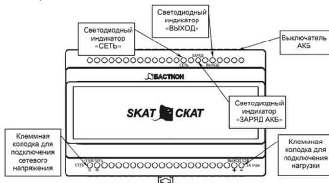
Рисунок 1 – общий вид источника
